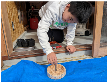
図4 端の深さを揃えるために径の小さいボアビットを合わせる
