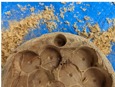
図1 小さいボアビットであけた穴
