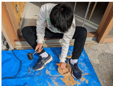
図2 ノミと槌で削るようす
