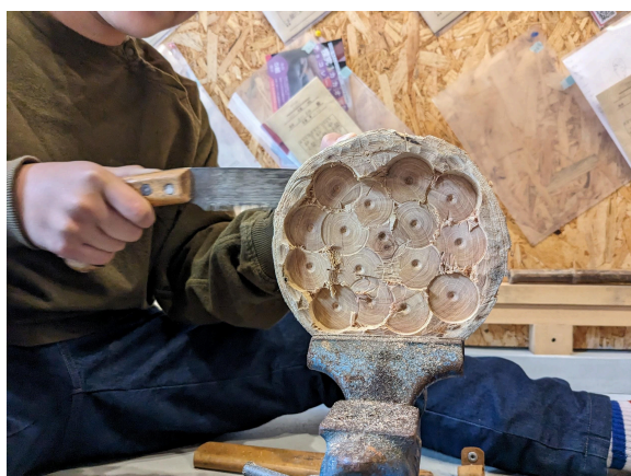
図3 斜めの部分をのこぎりを使って切り落とすようす
