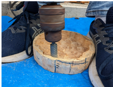
図2 サンダービットで周りを平らにする
