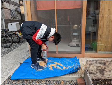
図2 ボアビットで深さをそろえる
